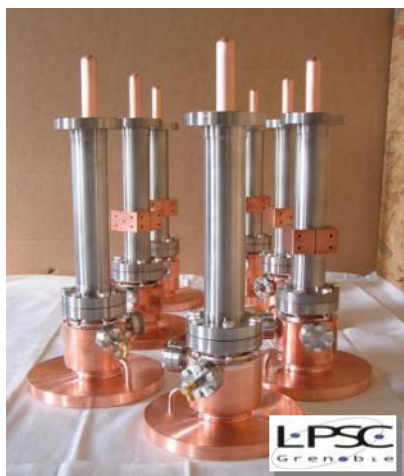
Coupleurs de puissance RF 10 kW
